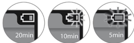
Quando a carga da bateria do AV400 está baixa, o indicador da bateria pisca uma luz amarela ou vermelha e emite repetidos bipes. Antes que a bateria se esgote, será exibido um alerta na tela, solicitando a recarga da bateria. Após recarregar, o AV400 reiniciará seu funcionamento normal.
