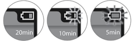
При низком уровне заряда батареи AV400 ее индикатор мигает желтым или красным светом и прибор подает периодические звуковые сигналы. Перед полным разрядом батареи на дисплей выводится сообщение о необходимости зарядки батареи. После зарядки AV400 возобновляет нормальную работу.
