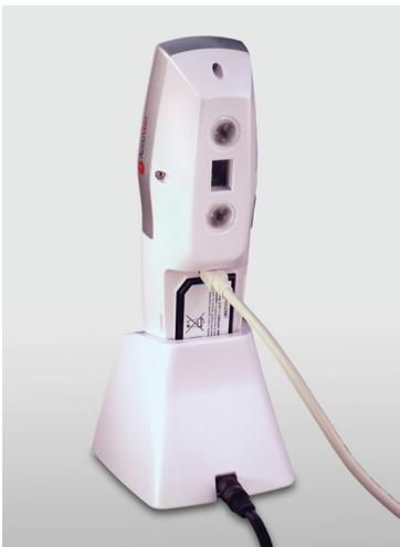
Ligue o cabo USB na porta USB do AV300, que se encontra por cima da bateria, e coloque o AV300 no respectivo carregador. Ligue a outra extremidade do cabo USB na porta USB do seu computador. A seguir, inicie a aplicação informática do AV300, que começa a procurar o AV300 conectado. **Certifique-se de que o AV300 se encontra no respectivo carregador enquanto está ligado ao computador.** O AV300 cabe no carregador com a tampa da bateria retirada.
