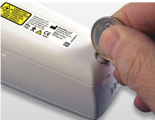
Uma vez instalada a aplicação informática do AV300 no seu computador, ligue o AV300 ao computador utilizando o cabo USB incluído com o aparelho. Para começar, retire a tampa da bateria do AV300 na parte de trás do aparelho. Utilize uma chave de fendas ou uma moeda pequena para soltar o parafuso que segura a tampa no seu lugar.
