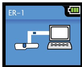
O LCD do AV300 indica que a interface USB está activa mostrando o ecrã animado ilustrado à esquerda. nenhuns botões do AV300 estão activos e nenhuns ícones dos botões do LCD são apresentados enquanto o AV300 está ligado a um computador. Desligue o cabo USB e volte a colocar a tampa da bateria para que o AV300 retome o funcionamento.
