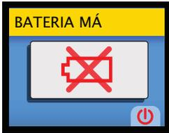
Para substituir a bateria, abra o compartimento da bateria na parte de trás do aparelho. Utilize uma chave de fendas ou o bordo de uma moeda pequena como ferramenta para retirar o parafuso.
