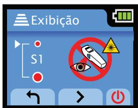
Quando colocado no suporte não alimentado, o indicador da bateria mostra a quantidade restante de duração da bateria, da mesma forma que quando se utiliza o AV300 como um aparelho portátil.
