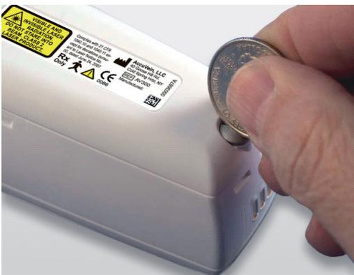
Une fois l'application du AV300 installée sur votre ordinateur, branchez le AV300 à l'ordinateur à l'aide du câble USB fourni. Pour commencer, retirez le cache de la batterie du AV300 situé à l'arrière. Utilisez un tournevis ou une petite pièce pour dévisser la vis fixant le cache.
