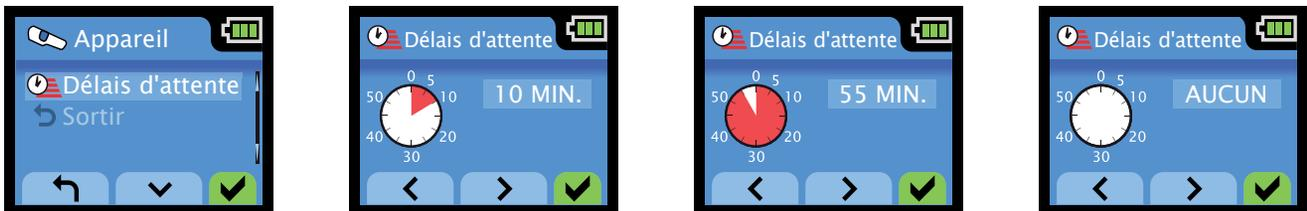
**Délai de l'appareil** : pour préserver l'alimentation de la batterie, le AV300 s'éteint automatiquement après être resté inactif pendant plus de 5 minutes (la lumière d'affichage est éteinte et aucun bouton n'est enfoncé). Le AV300 se trouve dans un socle mains libres alimenté, auquel cas il reste allumé jusqu'à ce qu'il soit éteint manuellement.
