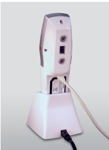
Branchez le câble USB au port USB du AV300, situé au-dessus de la batterie et placez l'appareil dans sa station de chargement. Branchez l'autre extrémité du câble USB au port USB de votre ordinateur. Puis, lancez l'application du AV300 qui recherche le AV300 connecté. **Laissez le AV300 dans sa station de chargement lorsqu'il est branché à l'ordinateur.** Le AV300 s'encastre dans la station sans le cache de la batterie.
