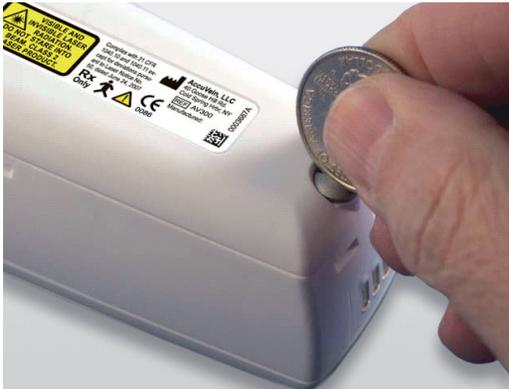
La batterie BA300 peut être facilement retirée du compartiment ou insérée, car sa forme épouse celle du compartiment batterie du AV300.
