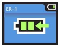
Когда батарея AV300 разряжается (индикатор состояния батареи мигает желтым или красным светом), ее необходимо зарядить путем помещения прибора в базу для зарядки так, чтобы ЖК-экран был обращен вперед. При нахождении AV300 в базе для зарядки лазер не будет функционировать, поэтому прибор не может быть использован. В процессе зарядки AV300 будет показано динамическое изображение батареи.
