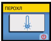
Если AV300 определяет, что правильное функционирование невозможно, он отключает лазер и выдает сигнал о неисправности. Сигналы возникают при использовании прибора при слишком низких (ниже 5°C) или слишком высоких (выше 40°C) температурах. При возникновении сигнала о температурах достаточно проследить, чтобы AV300 использовался в пределах соответствующего диапазона температур.
