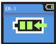
AV300의 배터리가 약해지면 (배터리 표시가 노란색이나 빨간색으로 변함), LCD 스크린이 바깥쪽을 향하도록 충전기에 놓음으로써 배터리를 재충전해야 합니다.
