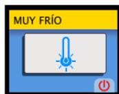
Si le AV300 détecte qu'il ne peut fonctionner correctement, il éteint la lumière d'affichage de la veine et affiche une alerte ou un écran de panne. Les alertes s'affichent si vous utilisez l'appareil dans un environnement trop froid (moins de 5°C) ou trop chaud (plus de 40°C). Si une alerte de température s'affiche, il vous suffit de ramener le AV300 dans sa plage de températures de fonctionnement.
