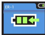
当AV300的电池电量降低时(电量指示闪动黄色或红色),您应该将其置于充电座上对电池充电(LCD屏幕向外)。当AV300置于充电座时,静脉显示灯不会亮,并且器械也不能使用。AV300充电时,屏幕上会显示动画充电图标。
