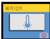
如果AV300检测到它不能正常运行, 它将关闭静脉显示灯并且发出告警或故障显示。 如果您在太冷 (低于5° C/41° F) 或太热 (超过40° C/104° F) 的环境下使用器械, 都会出现告警。如果出现温度告警, 您只需将AV300恢复到正常的使用温度范围即可。
